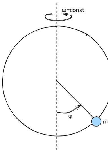
Положения равновесия:  $\Pi = -mgl \cos \varphi, \frac{\partial \Pi}{\partial \varphi} = 0 \iff \varphi = \pi k$
